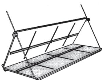
**NL** Eenvoudig in te stellen vormmal voor het afkoelen van werkstukken in iedere gewenste hoek. Lengte 500, 1250 en 2200 mm. Tevens 3 meter vormmal voor het vouwen en koelen van grote series T- en L-vormige displays.
