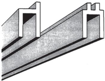
**NL** Dunne foliën, dikte 0.3-1mm, kunnen met het foliebuigprofiel strak gebogen worden. Deze foliebuigprofielen zijn in diverse uitvoeringen leverbaar. Lengte 500, 650 en 1250mm.
